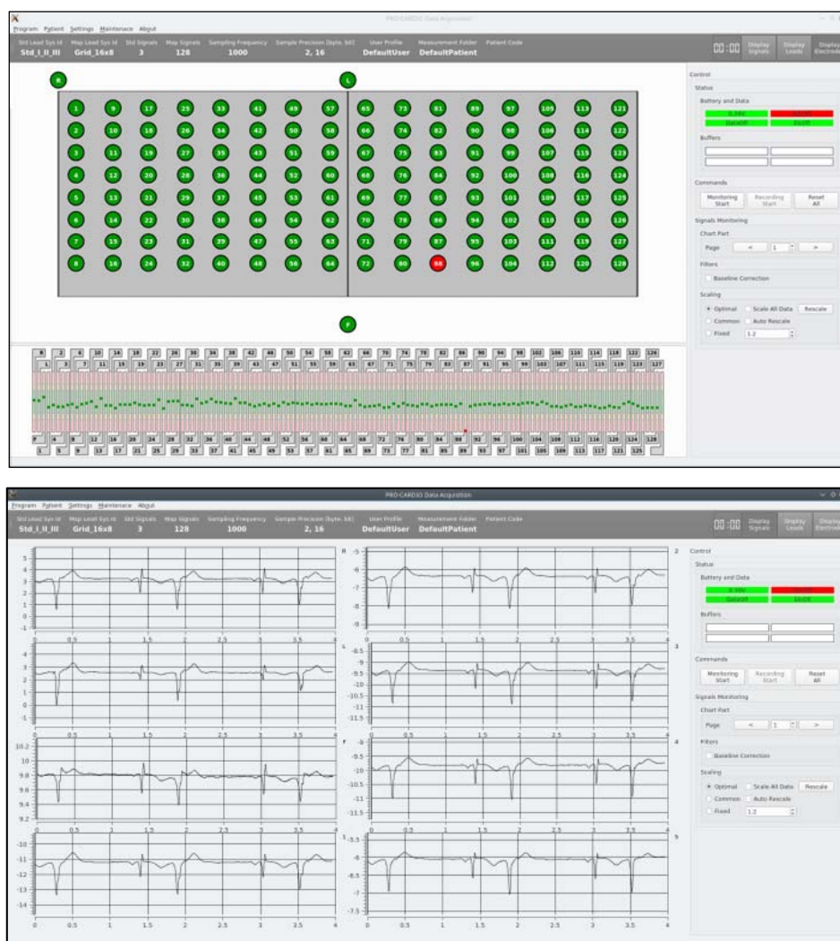
Obr.1. Príklad monitorovania kontaktov snímacích elektród (vľavo) a zaznamenávaných signálov (vpravo) pri 128-kanáľovom meraní EKG. Parametre merania a zobrazovania sa zobrazujú a nastavujú pomocou riadiaceho panelu v pravej časti obrazovky.
