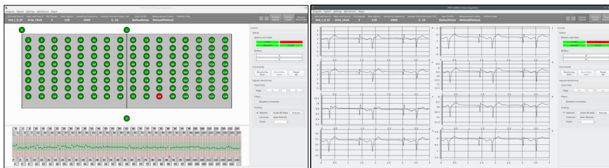
Obr.1. Príklad monitorovania kontaktov snímacích elektród (vľavo) a zaznamenávaných signálov (vpravo) pri 128-kanálovom meraní EKG. Parametre merania a zobrazovania sa zobrazujú a nastavujú pomocou riadiaceho panelu v pravej časti obrazovky.
