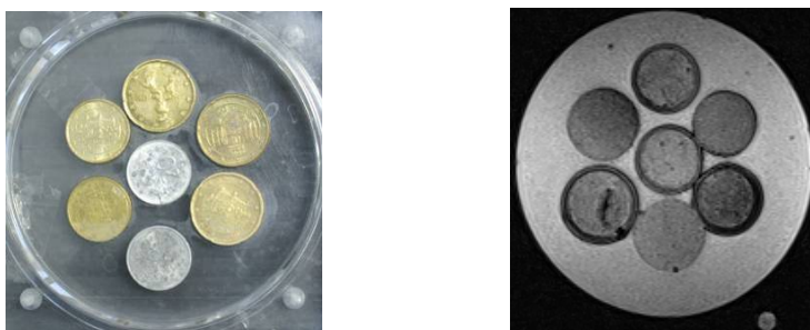
Obr. 2. Príklady zobrazenia komerčných mincí za použitia sekvencie Gradient-echo. Materiálové nehomogenity sú jasne viditeľné.
