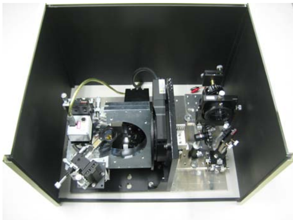
Obr.1. Scatterometer na rýchle a presné meranie distribučnej funkcie odrazeného svetla (vľavo) a užívateľské rozhranie vyvinutého meracieho softvéru (vpravo).
