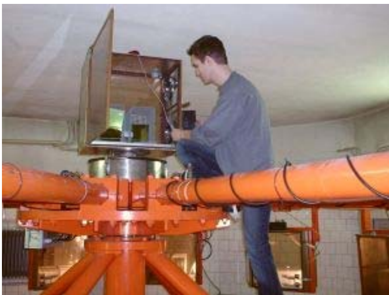
Montáž kontrolnej časti telemetrického systému na nosnú os centrifúgy
