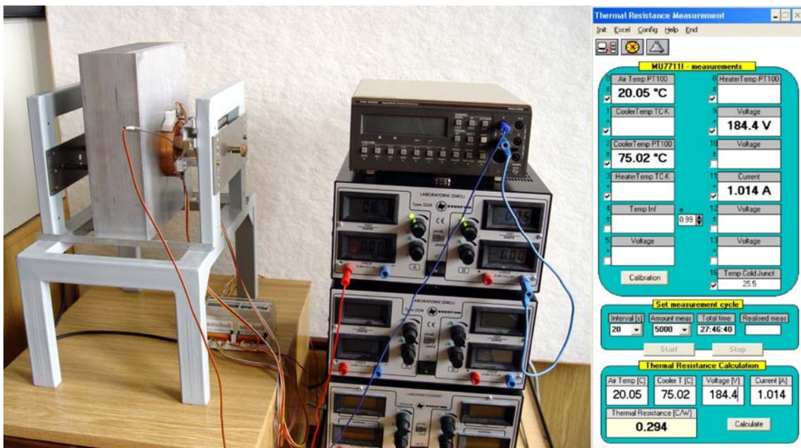
Obr. 1. Pohľad na merací systém a užívateľské rozhranie programu na meranie tepelného odporu hliníkových chladičov.
