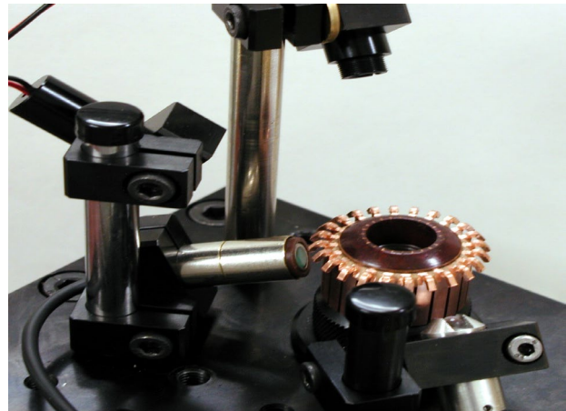
Laserový optický prístroj na meranie rozmerov komutátorov
