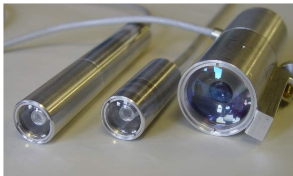
Laserové optické snímače na zisťovanie povrchových vád automobilových súčiastok
