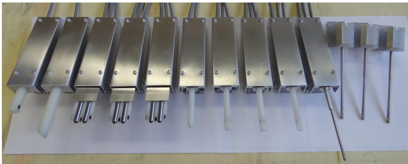
Vývoj a výroba snímačov na testovanie odliatkov blokov automobilových motorův v spolupráci s firmou Datalan
